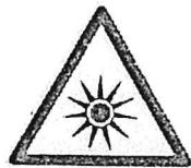
Rischio legato alla presenza di apparecchiature sorgenti di luce visibile, radiazioni infrarosse e ultraviolette.
